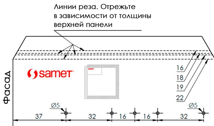
Линии реза. Отрежьте в зависимости от толщины верхней панели
