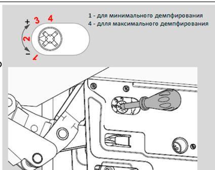
Для регулировки положения фасада воспользуйтесь винтами в рычагах подъемника:
