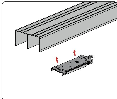
12 Регулировка нижних роликов по высоте.
