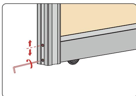
15 Схема регулировки улавливателей
