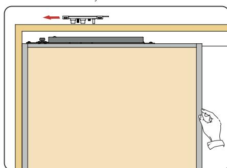
14 Откройте дверь, зафиксируйте улавливатель
