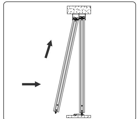
13 Толкните дверь. После срабатывания доводчика переместите дверь далее по ходу движения до нужного положения. Улавливатель автоматически установится
