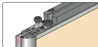
6 При использовании симметричного профиля придерживайтесь положения ноль при фиксации доводчика
