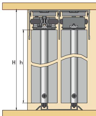
$$h \text{ (высота двери)} = H \text{ (высота проёма)} - 41 \text{ мм}$$
