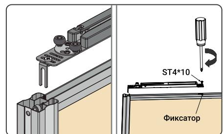
4 Регулировка положения распорных роликов
