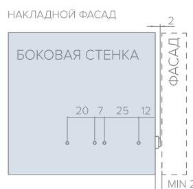
МИНИМАЛЬНЫЙ ЗАЗОР МЕЖДУ ФАСАДОМ И БОКОВОЙ СТЕНКОЙ СОСТАВЛЯЕТ 2 ММ.
