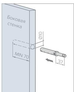
ПРОСВЕРЛЕНЕ В ТОРЦЕ БОКОВОЙ СТЕНКИ ОТВЕРСТИЕ Ø10 ММ И ГЛУБИНОЙ МИНИМУМ 70 ММ.
