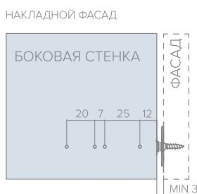
МИНИМАЛЬНЫЙ ЗАЗОР МЕЖДУ ФАСАДОМ И БОКОВОЙ СТЕНКОЙ СОСТАВЛЯЕТ 3 ММ.
