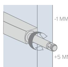
РЕГУЛИРОВКА ЗАЗОРА ОСУЩЕСТВЛЯЕТСЯ ПУТЕМ ВРАЩЕНИЯ ПОДВИЖНОЙ ЧАСТИ ТОЛКАТЕЛЯ.
