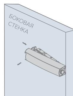
ДЛЯ СНЯТИЯ ТОЛКАТЕЛЯ, НАЖМИТЕ СЗАДИ НА ФИКСАТОР И СНИМИТЕ ДЕКОРАТИВНУЮ ЗАГЛУШКУ С ТОЛКАТЕЛЕМ. ДОСТАНЬТЕ ТОЛКАТЕЛЬ.
