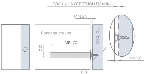
МИНИМАЛЬНЫЙ ЗАЗОР МЕЖДУ ФАСАДОМ И БОКОВОЙ СТЕНКОЙ СОСТАВЛЯЕТ 3.8 ММ. РЕГУЛИРОВКА ЗАЗОРА ОСУЩЕСТВЛЯЕТСЯ ПУТЕМ ВРАЩЕНИЯ ПОДВИЖНОЙ ЧАСТИ ТОЛКАТЕЛЯ. ДИАПАЗОН РЕГУЛИРОВКИ: -1...+5 ММ.
